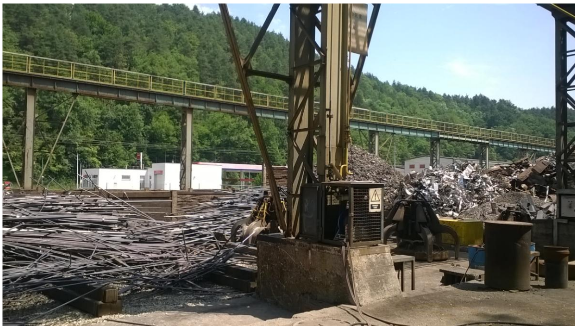
Slika 4: Ekskurzija v podjetje Štore Steel, d. o. o., ogled zbiranja in sortiranja odpadnega jekla pred postopkom taljenja (foto: Urška Fric).
